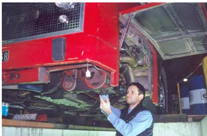
Judicaël entretient le PCM-U : nouvelle pompe à eau (qu'il a lui-même achetée à CBM Le Mans) et remplacement du filtre à huile.
