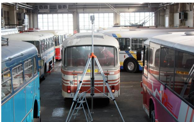
» Le scanner est placé à l'arrière du Saviem S-53-M
