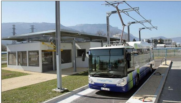
Un modèle de trolleybus à pantographe développé par IvecoBus avec le CEA de Grenoble. Plus besoin de ligne aérienne sur toute la durée du parcours. Le trolley se recharge dans des sous-stations. Les fils ne sont tirés que sur de courtes sections... Photo IvecoBus
