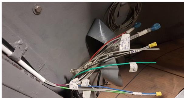
» Faisceau électrique refait à neuf par Joël, dans l'angle arrière gauche du Saurer
